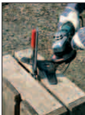
Kuva 33. Raivaussahan teränä käytettävää kolmioteraa täytyy säännöllisesti teroittaa. Kuva: Metla - Inkeri Sole.
